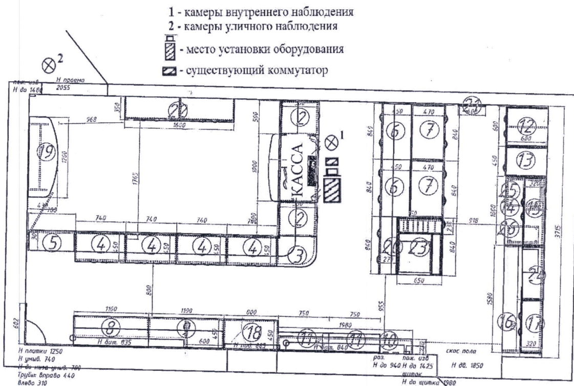
Схема расположения и установки оборудования.
